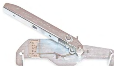
Figur 23: Anordning til måling af spændingskraft
