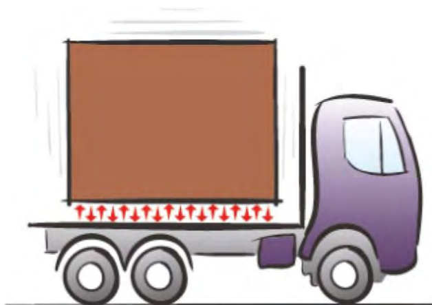
Figur 3: Vertikal vibration under kørsel
