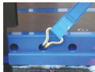
Figur 13: Ankerhuller i sideprofil
