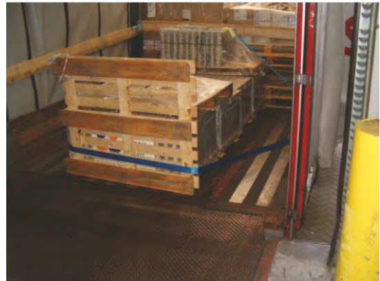
Figur 75: Anordning til fastgørelse bagud til blandet last
