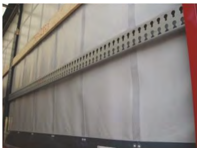
Figur 27: Aluminiumslægtemed hullertil blokeringsstænger
