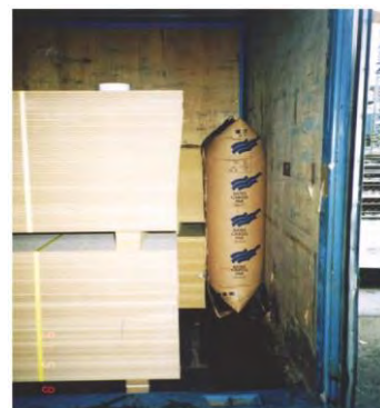
Figur 29: Luftpuder til blokering i siden
