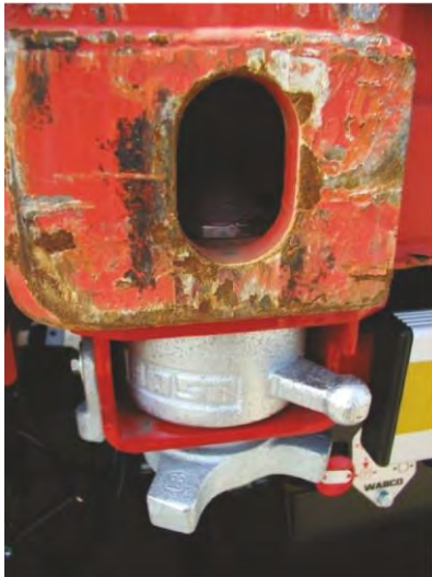
Figur 17: Drejelås med container
