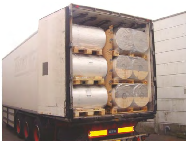
Figur 28 Fyldmateriale mellem rækker af last
