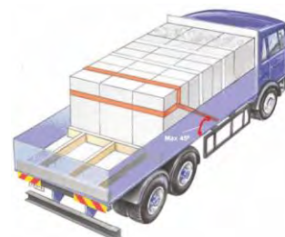
Figur 40: Fjederbelastet surring med sele
