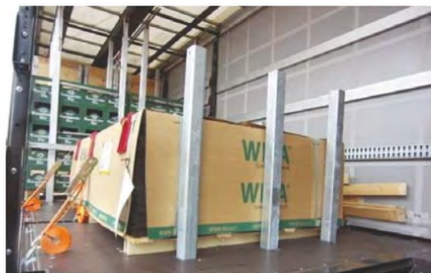
Figur 7: Kæpstokke anvendt til blokering i fremadgående retning
