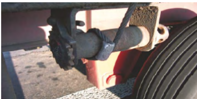
Figur 24: Stålwire spændt med spil
