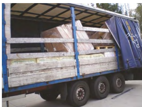
Figur 19: Utilstrækkelig fastgørelse af last udelukkende med strækfilm
