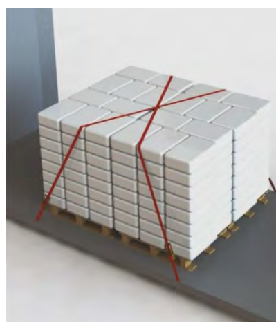
Figur 72: Fire paller med krydssurring
