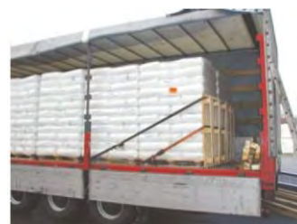
Figur 39: Fjederbelastet surring med paller
