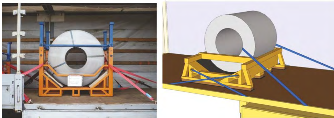
Figur 62: Særlig konstruktion til transport af spoler
